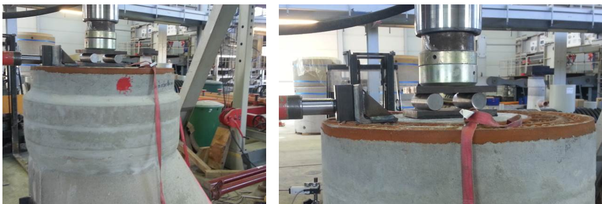
Bild 5 Versuchsaufbau Rad- und Bremslast: Übersicht (links); Vertikale Kräfteinleitung mit Rollenlager und horizontale Kräfteinleitung mit Handzylinder (rechts)
