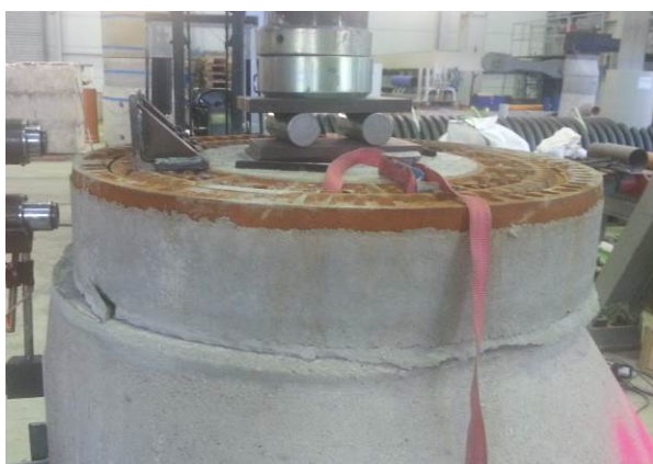
Bild 7 System ohne Verschiebesicherung: Scherbruch in der Fuge Konus-Schachtrahmen i.M. bei 55 KN (links) und Scherbruch in der Fuge Konus-Ausgleichsring i.M. bei 80 KN (rechts)
