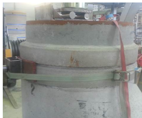
Bild 8 System mit Verschiebesicherung: Scherbruch in der Fuge Konus-Schachtrahmen bei i.M. 90 KN (links) und Kein Versagen der Fuge Konus-Ausgleichsring bei 132KN (rechts)
