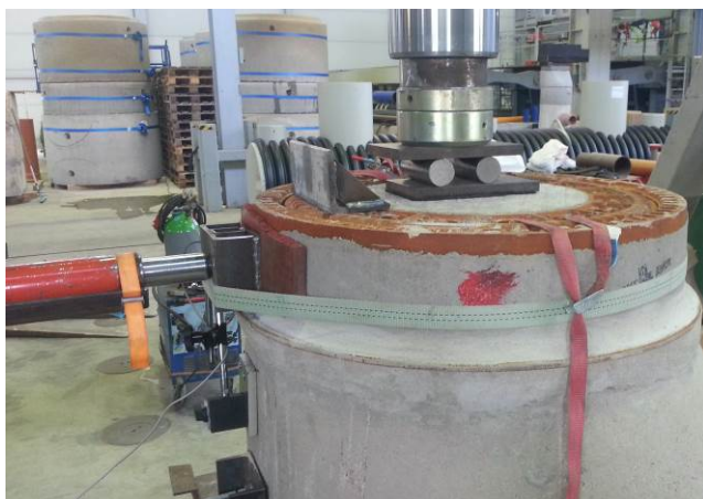
Bild 6 Versuchsaufbau für reine Scherbelastung: Horizontale Krafteinleitung mit Lastverteilung und vertikale Abhebesicherung mit Rollenlager
